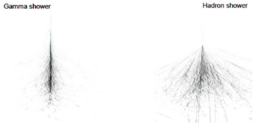
Figure 8: Simulazione di uno sciame elettromagnetico e di uno sciame adronico.
