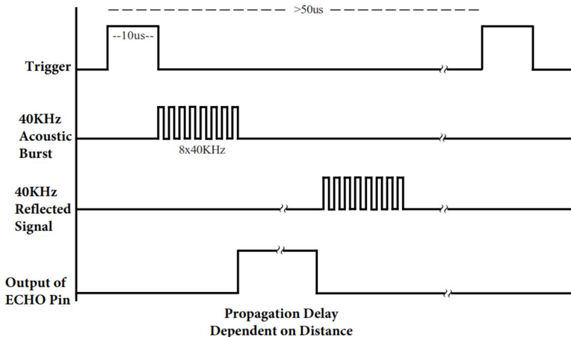
Il corretto pilotaggio del sensore prevede l’inserimento del comando `digitalWrite(triggerPort, LOW)`; per una durata di 5 μs prima dell’impulso di trigger.
