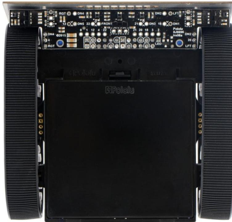
Figura 4: robot Zumo 32U4 visto dal basso.
