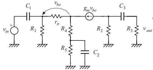
In figura è mostrato il circuito equivalente per il piccolo segnale; considerando i condensatori dei cortocircuiti, lo schema si modifica come indicato in figura seguente, in cui la resistenza  $R_C$  vale:
