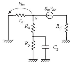
Per calcolare la costante di tempo associata a  $C_2$  procediamo in maniera analoga; in figura è mostrato il corrispondente circuito. Allo scopo di semplificare la determinazione escludiamo il ramo compreso tra il nodo  $N$  e massa e stabiliamo la resistenza equivalente  $R'_{e2}$  vista da questi due morsetti. Applichiamo, pertanto, un generatore di tensione e stabiliamo la corrente erogata; poiché risulta  $v_{be} = -v_2$ , segue:
