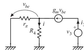
che è soddisfatta solo se  $v_{be} = 0$ . Quindi anche  $i = 0$  e pertanto la resistenza  $R'_{e3}$  è infinita. Così, dal circuito di figura segue che la resistenza  $R_{e3}$  vista  $C_3$  vale:
