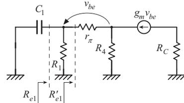
$$v_1 = i_1 r_\pi + (i_1 + i_1 g_m v_{be}) R_4 = i_1 [r_\pi + R_4 (1 + \beta)],$$
