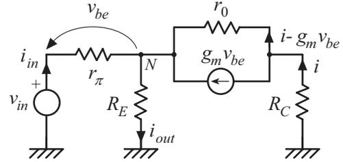
Trascurando il parametro  $r_{\mu}$  di valore molto superiore delle altre resistenze presenti nella rete, il circuito equivalente per l'amplificatore è quello mostrato in figura. Applicando la *KCL* al nodo  $N$  risulta:
