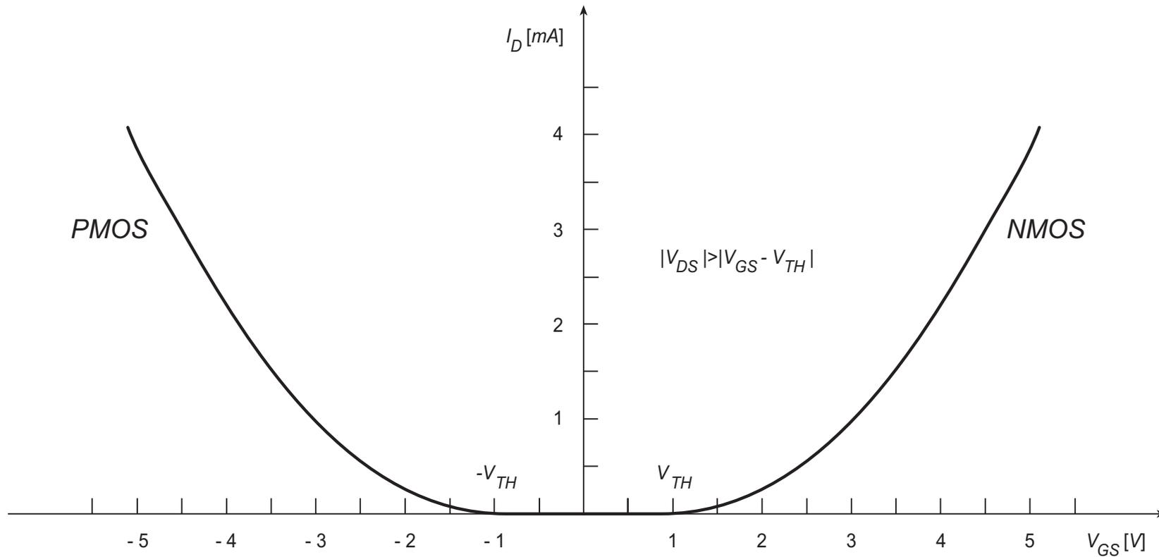
Caratteristiche  $I_D - V_{GS}$  per transistor MOSFET ad arricchimento di tipo  $n$  (a destra) e di tipo  $p$  (a sinistra) in saturazione ( $V_{TH} = 1$  V per l'NMOS e  $-1$  V per il PMOS,  $k_n (W/L) = 0.5 \text{ mA/V}^2$ ). Per  $V_{GS} = V_{TH}$  la corrente  $I_D$  è teoricamente nulla; in pratica, in un dispositivo discreto è dell'ordine del  $\mu\text{A}$ , mentre quella per  $V_{GS} = 0$ , detta  $I_{DSS}$  è dell'ordine del  $n\text{A}$ .
