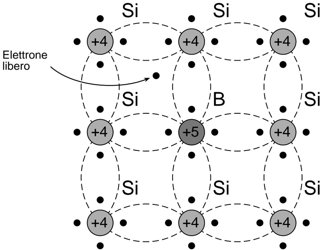
**Reticolo cristallino in cui un atomo di silicio è sostituito da un atomo di impurità trivalente (fosforo)**
