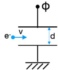
$C = Q/\Delta V$ , quindi calcolando la capacità di può ottenere la carica nota la differenza di potenziale. Per un condensatore ad armature piane e parallele la capacità e' pari
