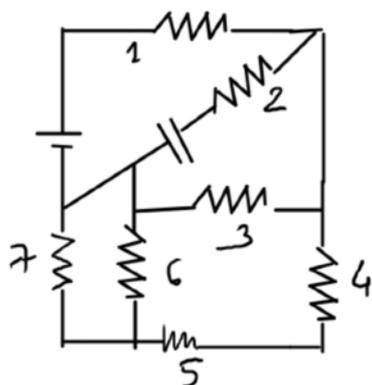
**Quesito 4: (fino a 10)** Il circuito in figura si trova in condizioni di funzionamento di regime; si calcoli la potenza erogata dal generatore e la carica sulle armature del condensatore. Si assuma  $R_1=R_3=R_5=1\text{k}\Omega$ ,  $R_2=R_4=2\text{k}\Omega$ ,  $R_6=R_7=3\text{k}\Omega$ ,  $\epsilon=20\text{ V}$ ,  $C=10\text{nF}$ .
