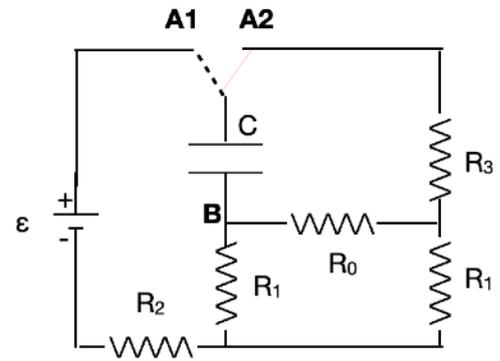
Si considerino i valori seguenti dei parametri circuitali:  $R_0=R_1= 1\text{k}\Omega$ ,  $R_2=R_3= 2\text{k}\Omega$ ,  $\epsilon=10\text{ V}$ ,  $C=200\text{nF}$ .
