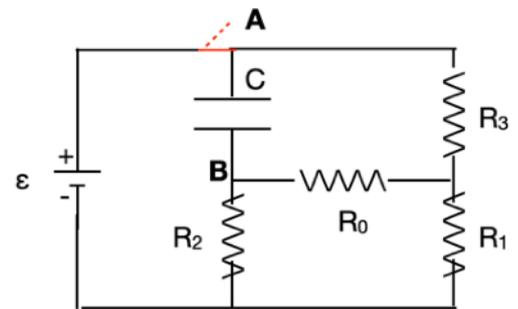
Nella prima fase, nel circuito a regime il condensatore si comporta come un interruttore aperto, perciò la corrente che scorre nel ramo del generatore può essere calcolata come  $i_g = \epsilon / R_{eq}$  dove  $R_{eq} = R_3 + (R_0 + R_2)R_1 / (R_0 + R_2 + R_1) = 1417 \Omega$ .
